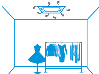
Rozkład powietrza z zabrudzonym filtrem
